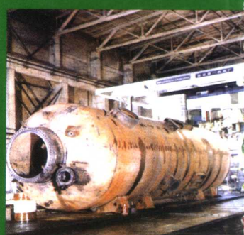
加压气化炉炉体整体加工
