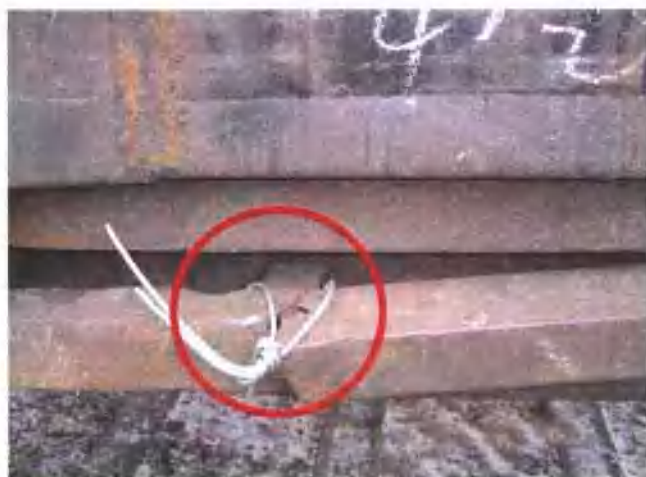
图 1-9 棚车车门滑道断裂
