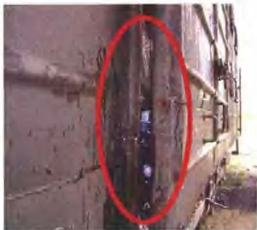
图 1-3 棚车车门窜动货物露出
