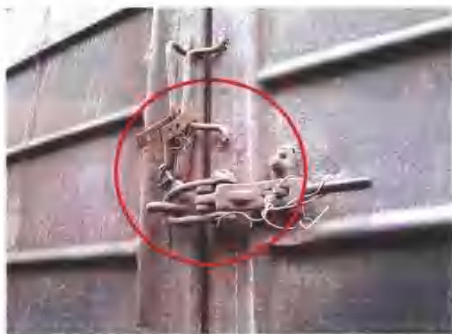
图 1-6 棚车施封插销丢失,门鼻无法施封,车门把手开焊
