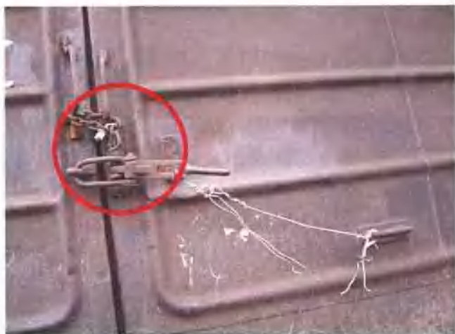
图 1-7 插销及插环全部丢失,使用铁链代替 U 形夹施封
