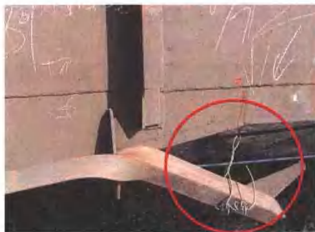
图 1-10 棚车车门滑道变形、开焊
