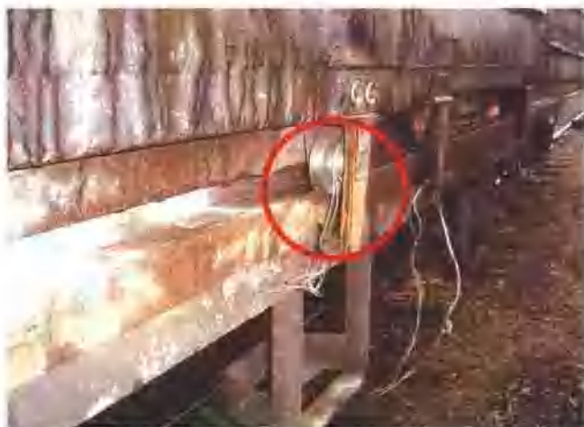
图 1-5 棚车车门滑轮出槽
