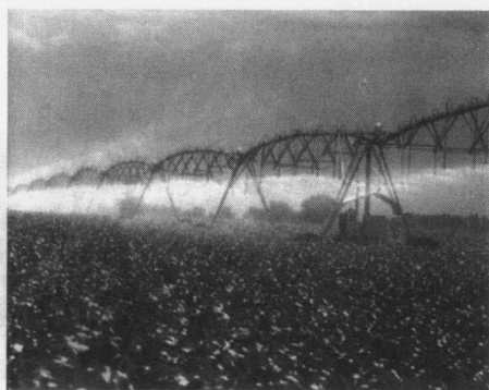
图 1-7 平移式喷灌机 (奥地利保尔 Bauer 公司)
