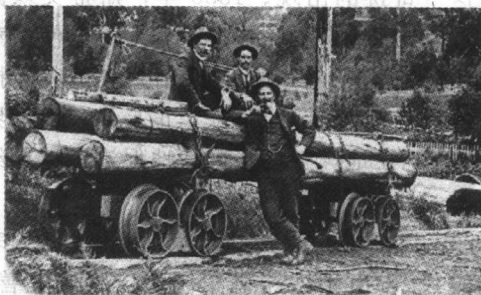
图 1-6 利用斜坡的无动力轨道车辆
