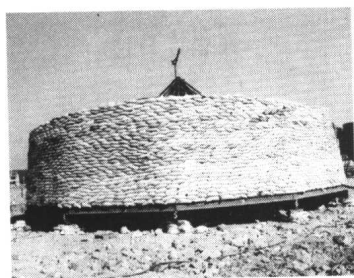
沙包堆载法抗压静载试验
