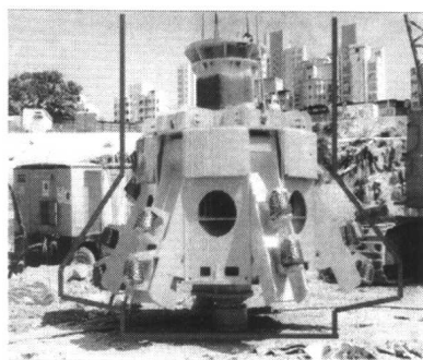
钻孔桩机械扩底钻头
