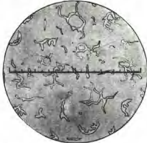
图2 割线法测量示意图, 测得数值为14格(14%)
