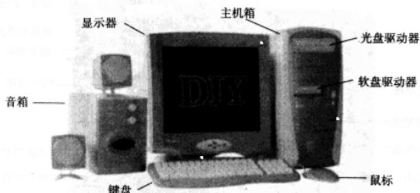
图 1-2 微型计算机系统的外观构成
