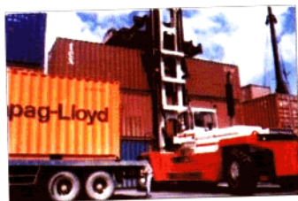
从国外引进的先进设备正在进行集装箱堆叠及水平运输作业
