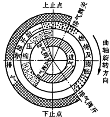
图 1-5 四冲程柴油机的正时圆图
