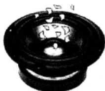
扬声器发声时小纸片上下跳动
