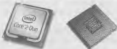
图 1-4 Core 2 型号 CPU (正面和引脚面)
