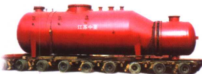
大连石化三苯T型槽道管高效换热器 ( \phi 2600mm, 89t)
