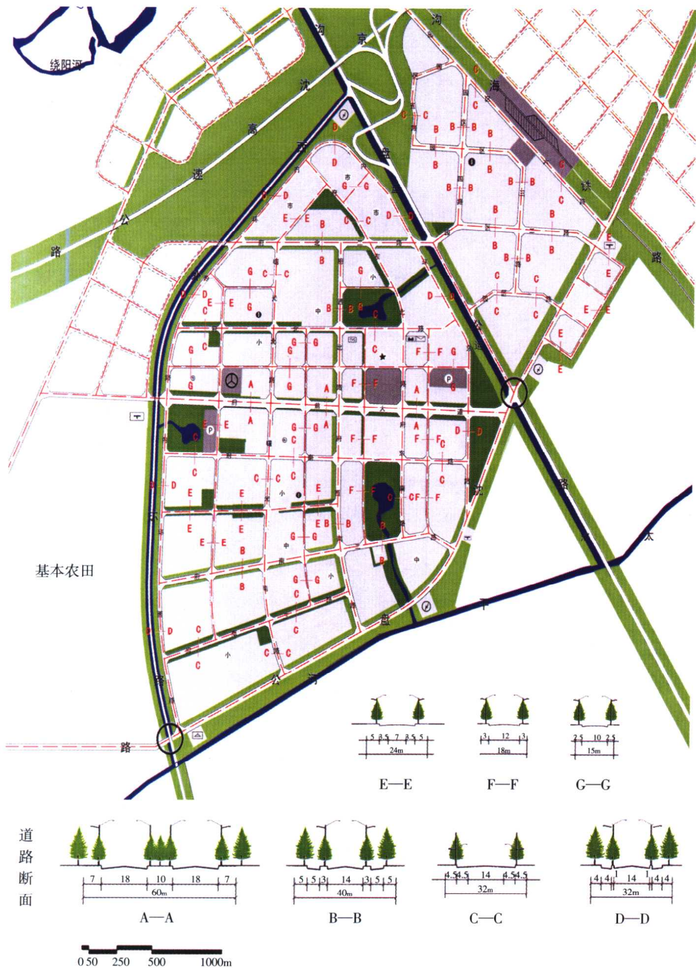
图 14.1.1-2 盘山县城总体规划道路断面规划图
