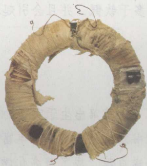
图4.1-2 法拉第用过的线圈
