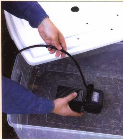
水泵保护。 将水泵放入一个过滤箱可以防止水泵阻塞，并有助于进行生物或机械净水。
