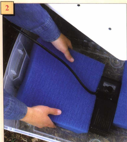
将1000加仑/小时(约3.8米 3 /小时)或更大容量的水泵放入过滤箱中，并用过滤膜将水泵包起来。在箱中装入用于生物过滤的介质。
