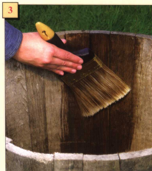
等桶完全干燥后，在通风良好的地方，用防水剂彻底涂刷其内部。
