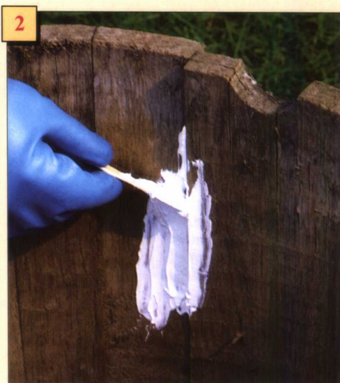
从桶的内侧，用环氧胶将孔洞填满封牢，并让其干燥24小时。等环氧胶干燥后，从外面将胶布撕去。
