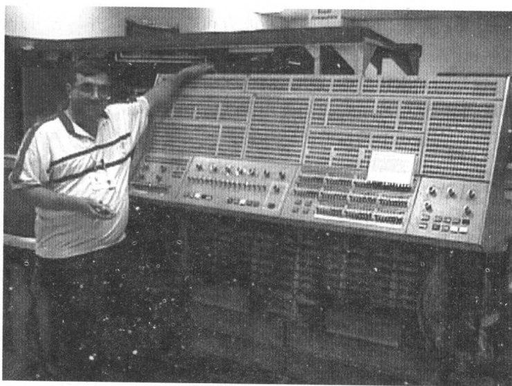
图 1-3 第三代电子计算机代表机型 IBM360 计算机系统
