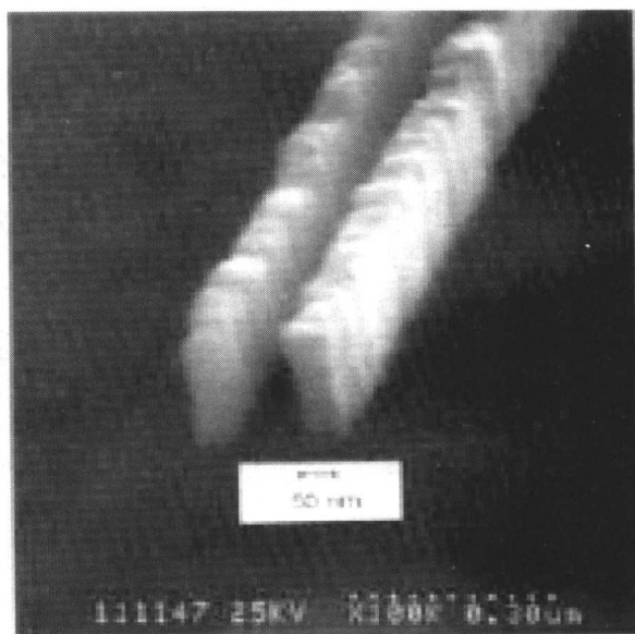
图 1-5 \text{Be}^{2+} 聚焦离子束在 PMMA 胶上的曝光结果(线宽 50\ \text{nm} )
