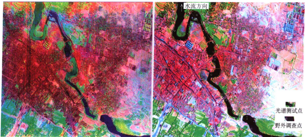
图版XIII 经过一阶导数运算之后的高光谱遥感图像(左)与原图像假彩色合成(右),左图中不同河段水体的颜色显著不同,野外调查证明颜色的差异是由于水体污染程度差异所致。在右图水体的色调变化肉眼难以区分,图中数字和符号为野外光谱测试点和调查点
