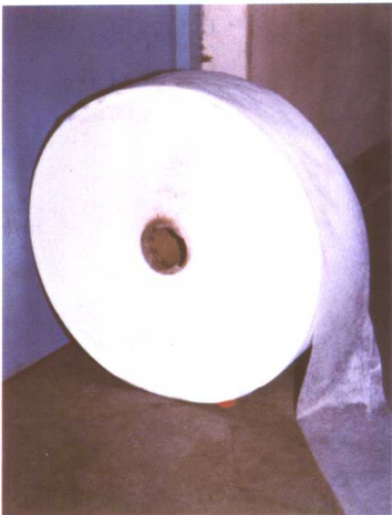
图 1.2 中国林业科学研究院林业研究所生产的半分解无纺布纤维材料
