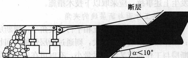
图 1-2 支撑式液压支架过断层
