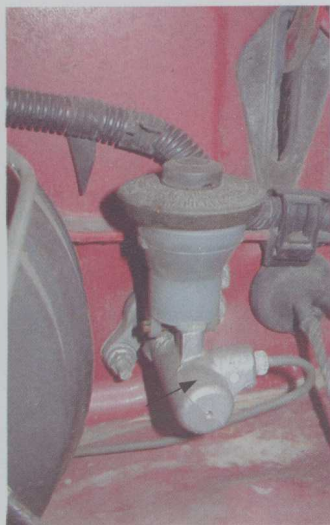
图 1-6 典型的离合器主缸和安装在汽车驾驶员侧车横板上的储油罐。系统工作时由液压系统中的制动液来驱动位于离合器壳上的工作缸工作
