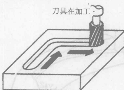
图 1-13 直线控制加工示意图
