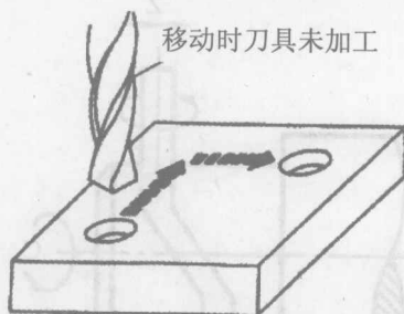
图 1-12 点位控制加工示意图
