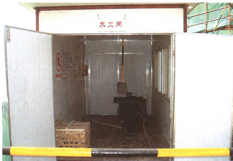
定型化木工间（上海建工集团）
