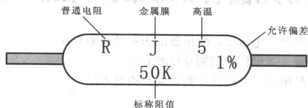
图 1-2 采用直标法的电阻器
