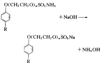
将一定量烷基酚加入反应釜中，在115~120℃下，于10~15min内加入计量好的氨基磺酸粉末，然后在120~125℃搅拌保温1h，冷却至70℃，得棕色黏稠液，用30%氢氧化钠溶液中和至pH值7.5~8.5，得烷基酚聚氧乙烯醚硫酸钠(OPES)，酯化深度大于85%。烷基酚聚氧乙烯醚与氨基磺酸，摩尔比为1.00：(1.05~1.15)。反应过程中物料摩尔比、氨基磺酸加入速度、反应温度、中和温度等因素，若控制不当均会影响产品色泽与酯化深度。本方法所得产品为棕色黏稠体。
