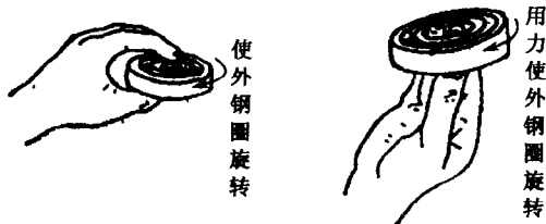
图 1-9 轴承的旋转检查
