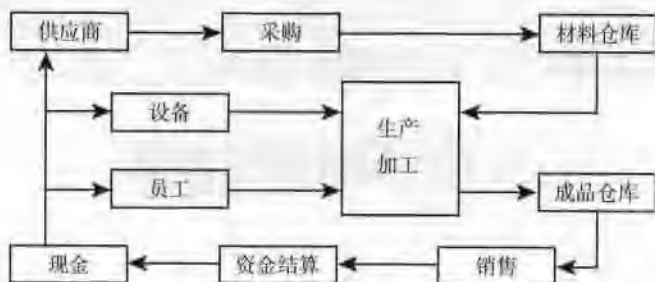
图 1-2 一般工业企业生产组织流程图
