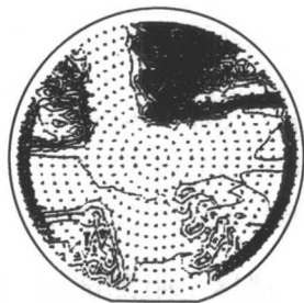
图 1-2 条纹实验 625 点的 薄层电阻图示
