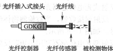
图 1-9 光纤式光电传感器示意图
