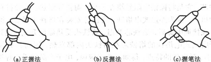
图 1-1-3 电烙铁的握法
