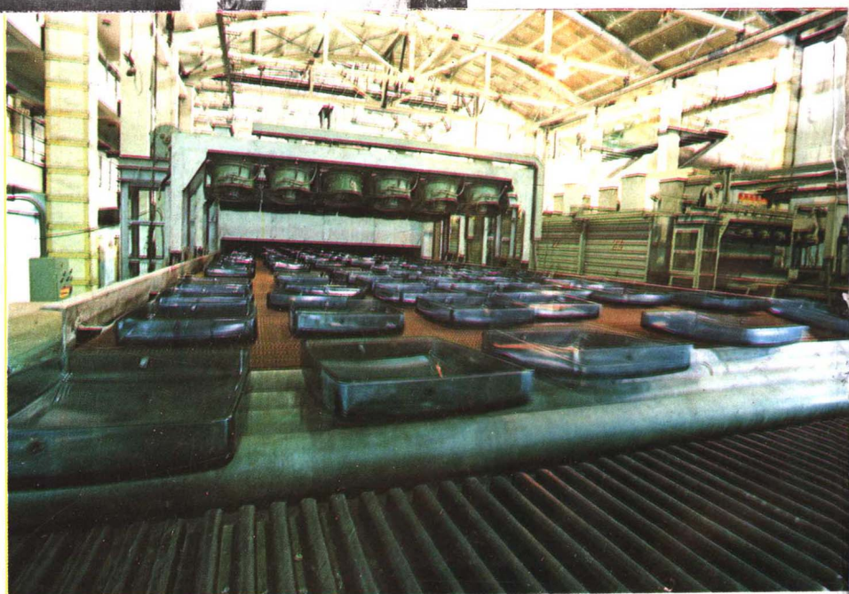
年产315万套的彩色显像管玻壳生产线退火炉。▶
