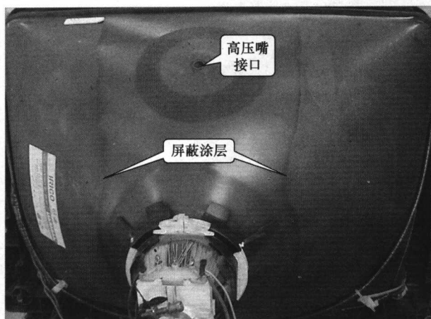
图 1-3 显像管的屏蔽涂层
