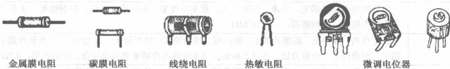
图 1.1 常用电阻器的外形结构及电路符号
