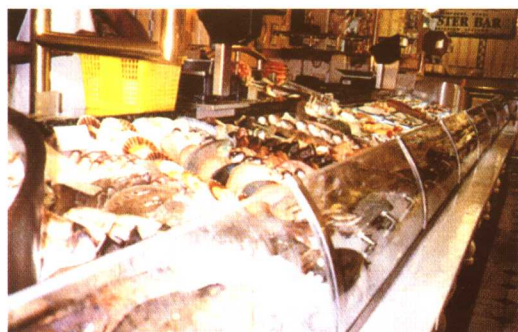
新的35ft的装满了冰块和新鲜鱼的柜子。冰块下面有22个投光器。冰块不会像以前一样快速的溶化，通过调节灯光的闪烁来引起注意
