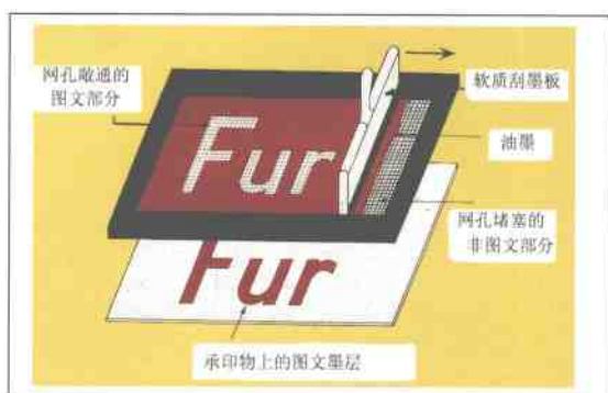
彩图1-4 丝网印刷示意图
