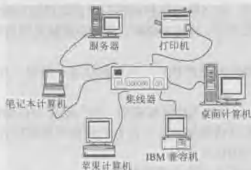
图 1-4 星型拓扑结构
