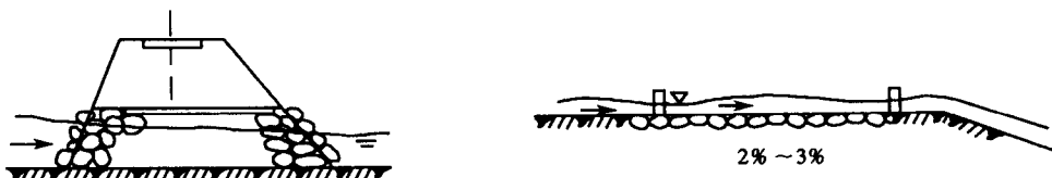
图 1-5 渗水路堤和过水路面
