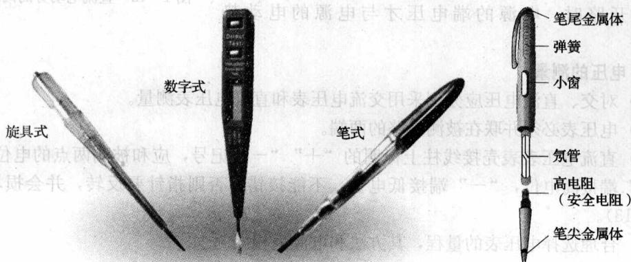
图 1—14 测电笔的结构和样式
