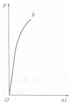
图 1.3 铸铁的力-伸长曲线
