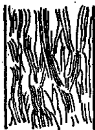
图1-5 结晶区与非结晶区示意图
