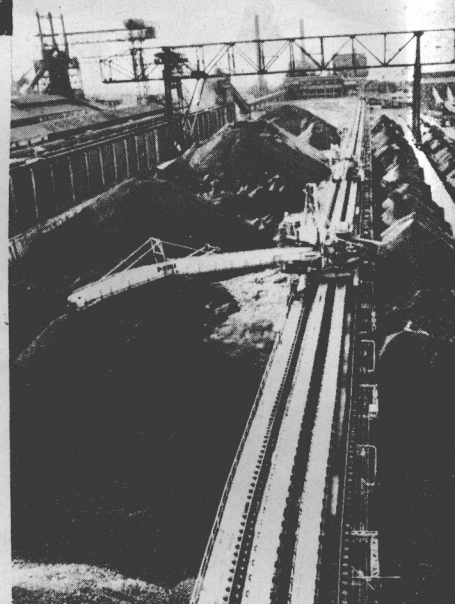
Fig. 28 每小時 600 噸堆煤機
