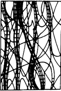
图1-3 纒状原纤模型 画成格子处为结晶部分
