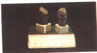
作为矿物硬度计的十种矿物晶体——滑石 (1)； 石膏 (2)；方解石 (3)；萤石 (4)；磷灰石 (5)； 正长石 (6)；石英 (7)；黄玉 (8)；刚玉 (9)； 金刚石 (10)
