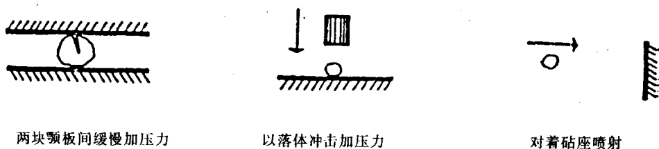
图 2-3 施加应力的三种方式
