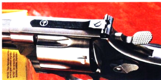
↑ 以前的照门固定板一直要延伸到枪管的后段靠前位置，但现行手枪只延伸到转轮的前端部位。
