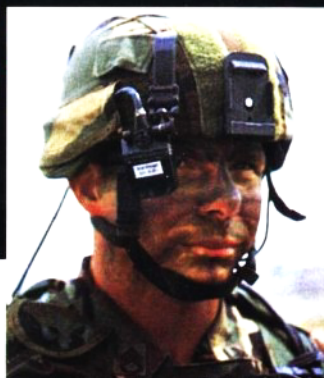
↑ 头盔上装备着右前方可装头上显示器和中央可装夜视护目镜的挂钩。
