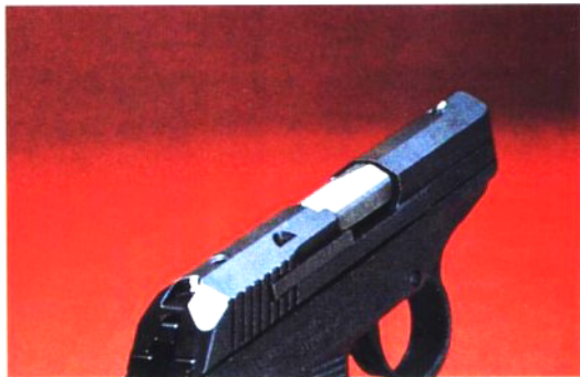
↑ 象征性地有点准星和照门的样子。从枪的使用目的来讲这已很充分了。
