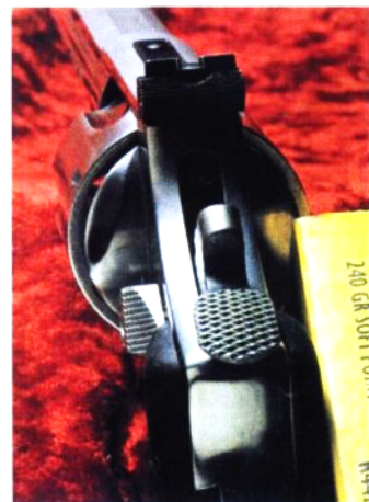
↑ 击锤上的手指按压部位设计得较宽，原先设置在击锤上的击针已去掉，而改设至枪底把内。
