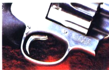
↑ M629 为双动扳机，图中扳机处于压倒击锤的位置，再向后扣扳机时就会解脱击锤，击发枪弹。
