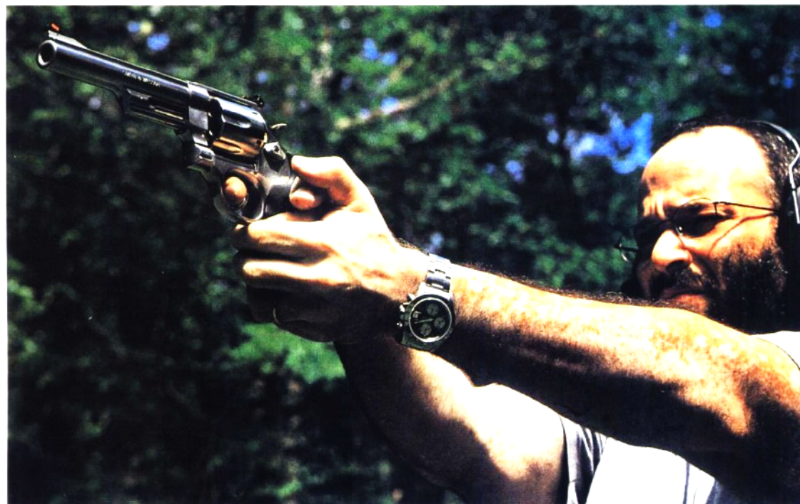
↑ M629 为双动扳机，图中扳机处于压倒击锤的位置，再向后扣扳机时就会解脱击锤，击发枪弹。
