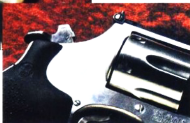
↑ 击锤上的手指按压部位设计得较宽，原先设置在击锤上的击针已去掉，而改设至枪底把内。
