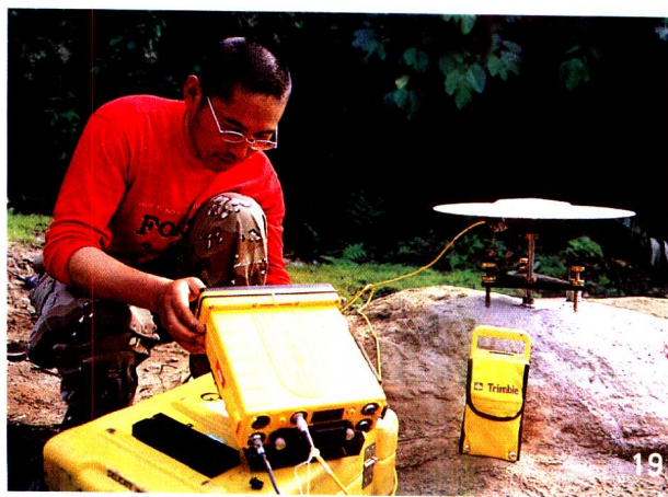
图 19. 测绘专家在墨脱背崩解放桥设立 GPS 测量基准点。
