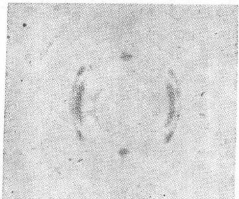
圖2. 压延了的鋁片的纖維的X-射线照片 (按照格洛克)
