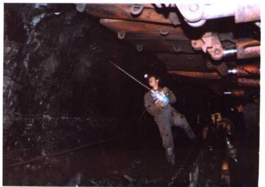
大雁矿务局二矿井下工人钻眼
