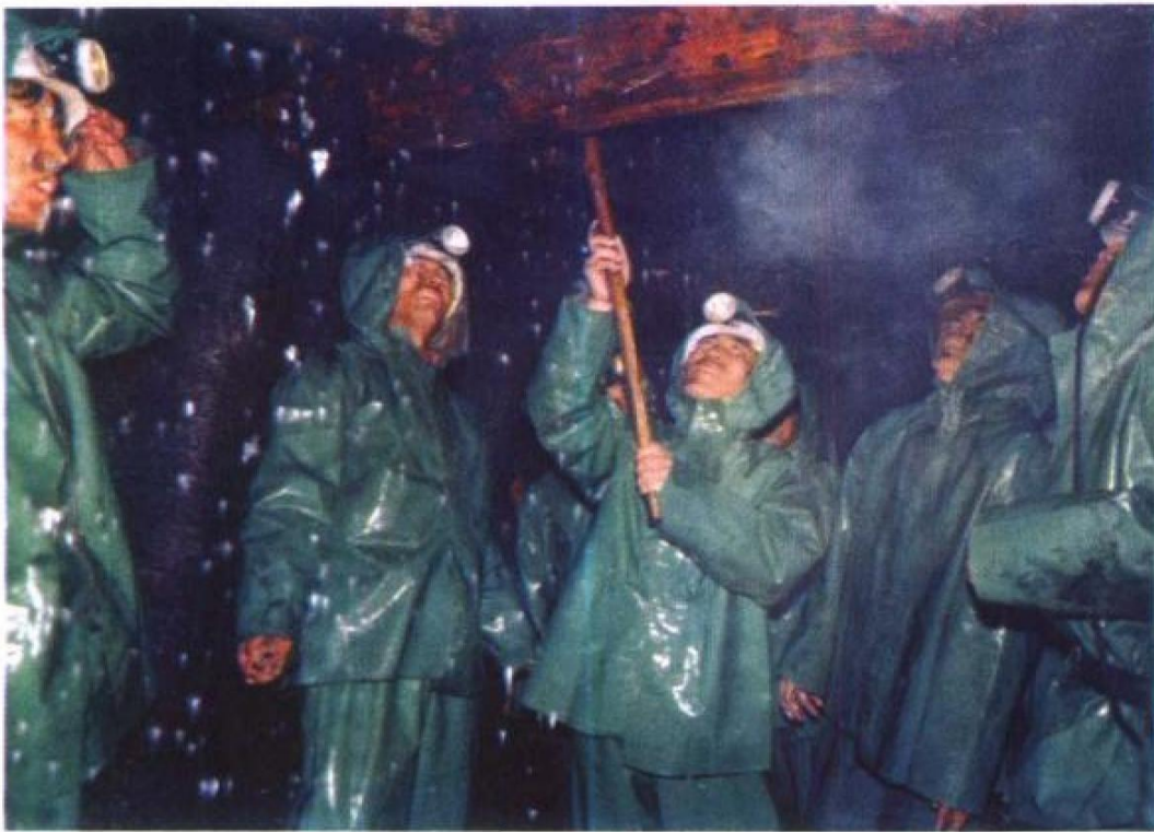
扎赉诺尔矿务局工人 在井下敲帮问顶
