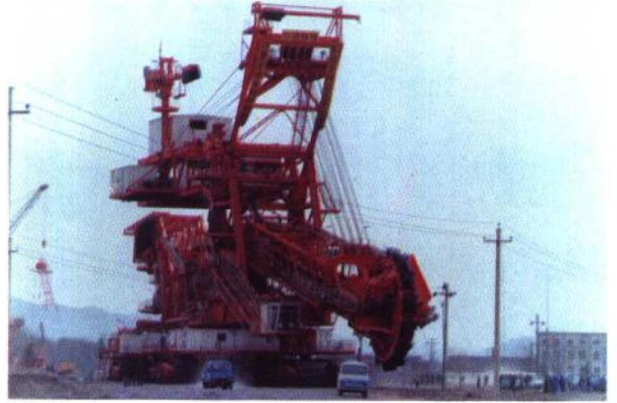
平庄矿务局元宝山露天矿从德国进口的挖掘机每小时挖掘能力为3600立方米，自重2700吨，是国内最大的轮斗挖掘机
