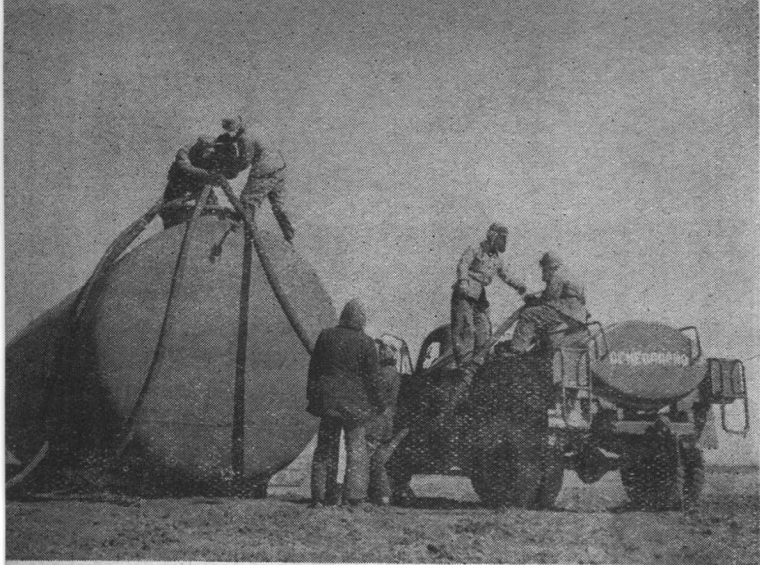
15. 國營友誼農場春播期間在田間設有儲油站,及時供給機器的油料。這是運油車正在往儲油罐內輸油。 新華社記者譚志發攝
