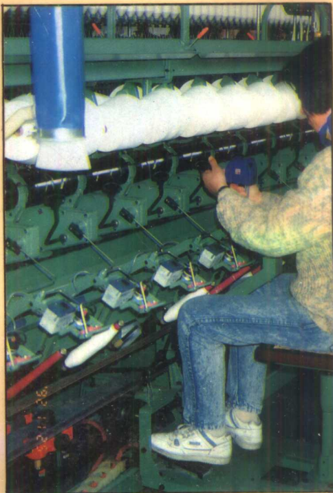
在国产新款 GAO13 络筒机上配 115 型空气捻接器固定在值车座上
